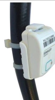
アセットタグクレードル を使用してマウント されたT2sタグ
